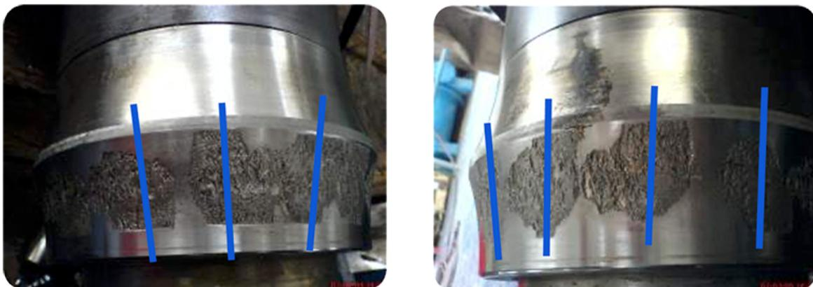
Fig. 10: Condizioni potenzialmente dannose. Erosioni precoci e profonde a passo rulli.
