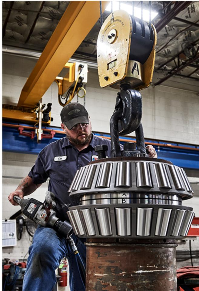
Figura 1: Montaggio con albero in posizione verticale.
